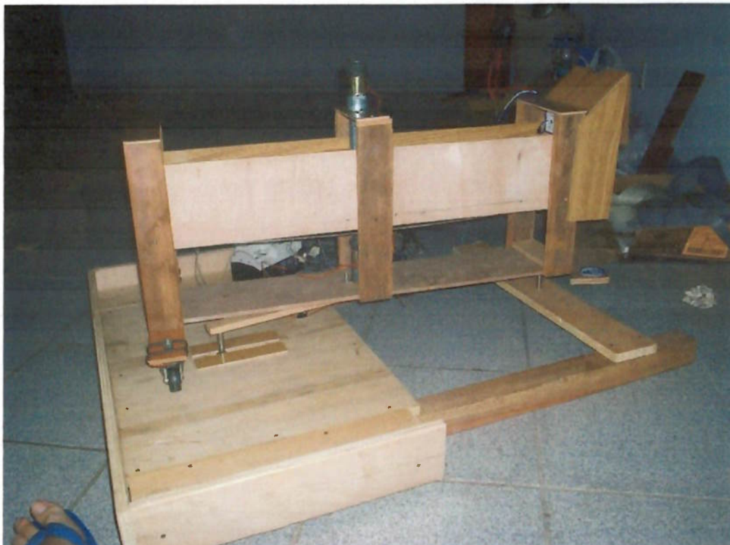
Figura 20: Foto lateral esquerda - esbarros laterais, rodas para permitir o giro
