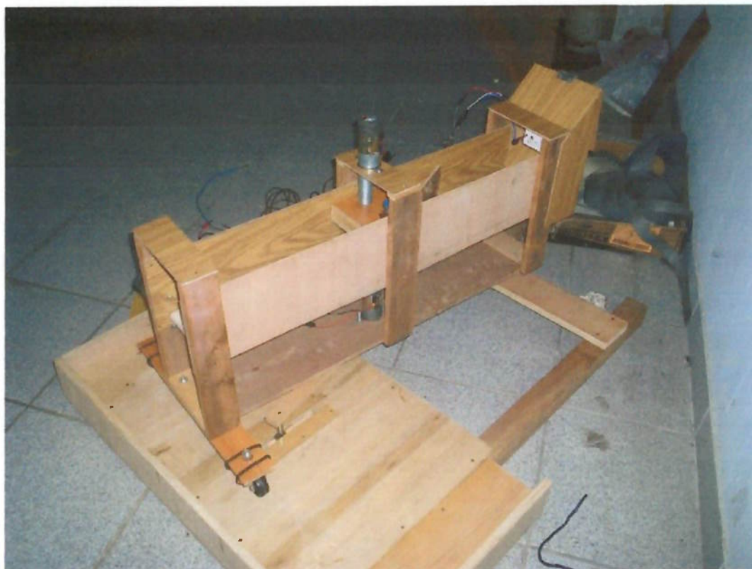
Figura 19: Foto superior esquerda - fuso da prensa, motor de posicionamento
